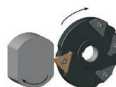
1枚刃カッターでの2面幅加工。
