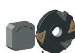
2枚刃カッターでの4面幅加工。
