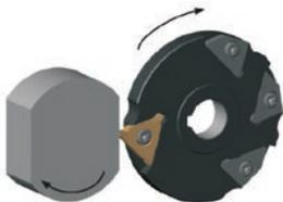
1枚刃カッターでの2面幅加工
