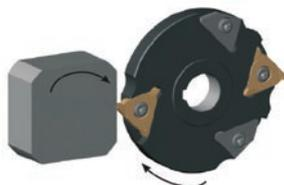
2枚刃カッターでの4面幅加工
