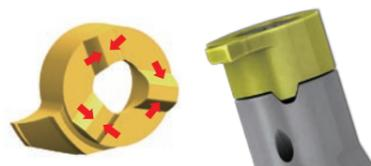
クランプ部分がテーパ形状になっており、ねじ1本の締付で6面を拘束し、確実なクランプを保證します。
