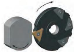
1枚刃カッターでの2面幅加工
