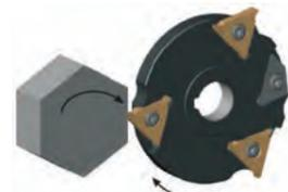
3枚刃カッターでの6面幅加工
