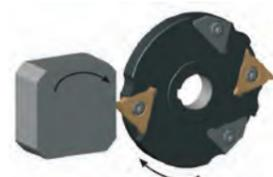
2枚刃カッターでの4面幅加工
