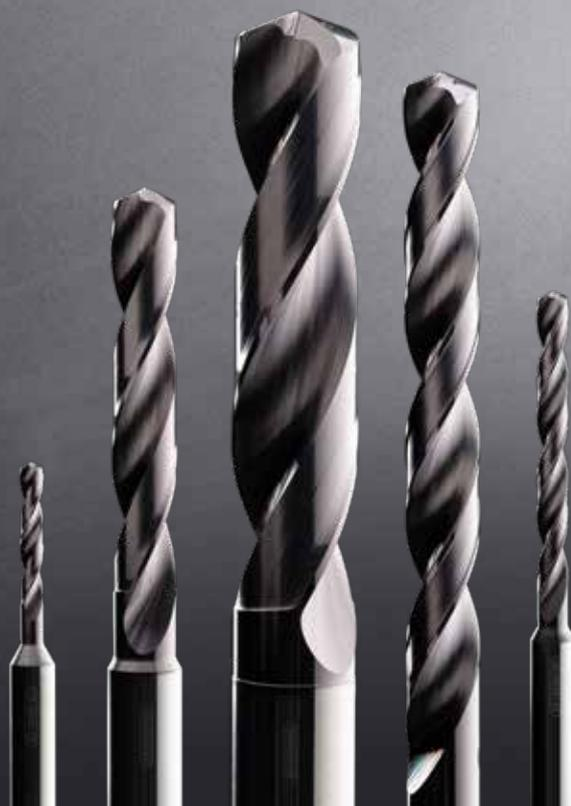
HORNのD1122超硬ソリッドドリルシリーズは鋼および鋳造材の加工に最適で生産的で経済的なドリル加工を行う新世代の工具である。直線的な切れ刃は非常に安定した加工を行い構成刃先の形成を抑える。さらにコーナー部の面取り処理で刃先の耐摩耗性を高め工具寿命を延ばす。特別に開発され自社で行われるHiPIMSコーティングはさらに高いレベルの刃先保護を行う。精密に研磨された刃溝で、安定した切りくず除去を行う。
