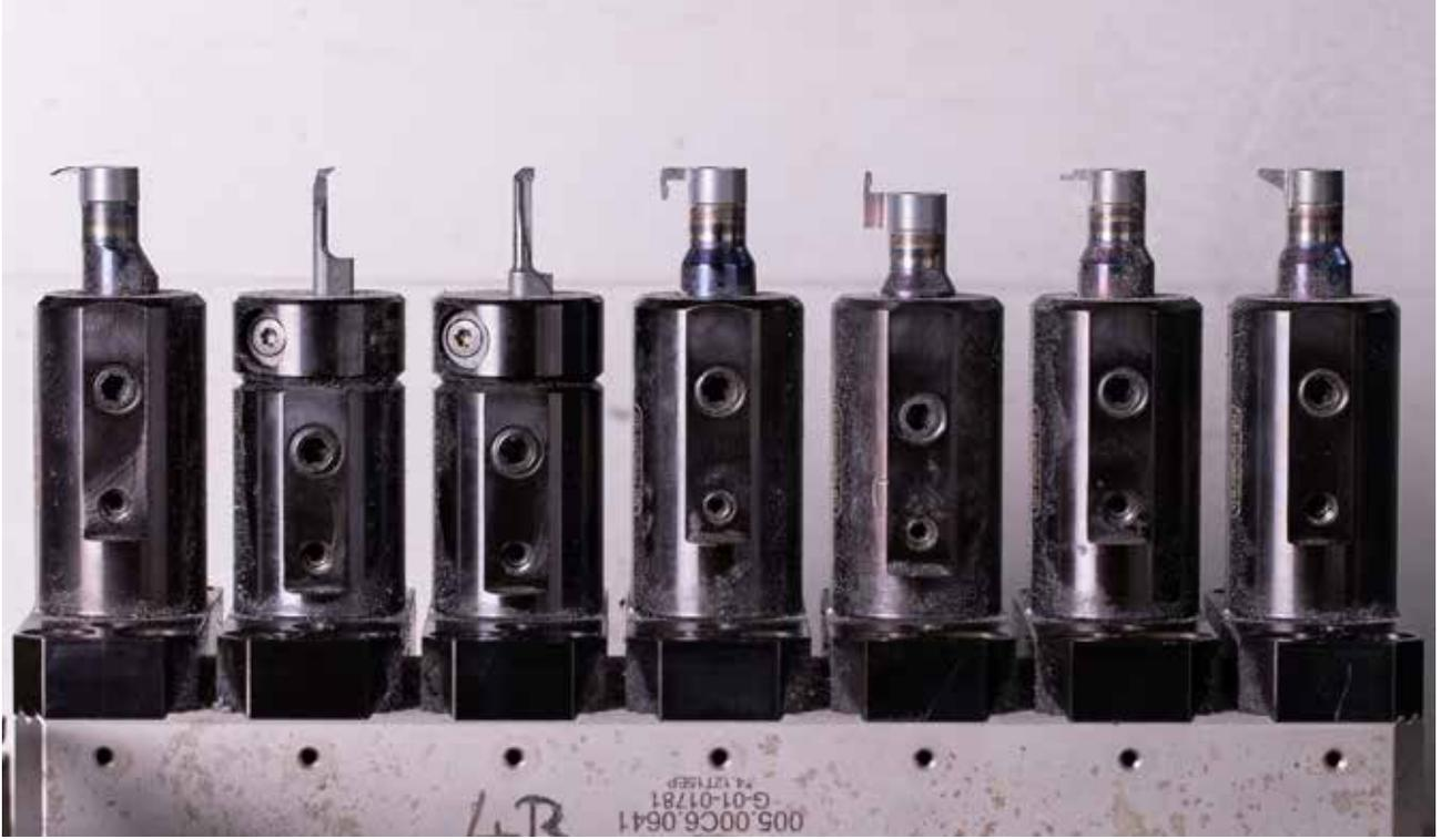
それぞれの加工に適したスーパーミニとミニが工具台に取り付けられている
