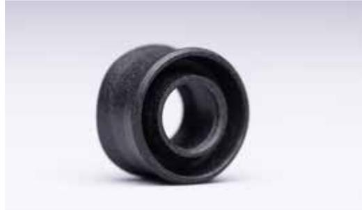
端面に2つの溝を持つシールは、ワンチャッキングで加工できる
