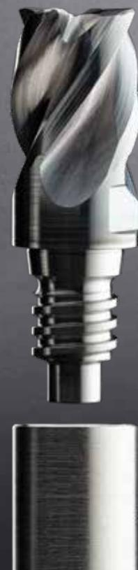
1,000点を優に超える特殊品対応例と、幅広い標準品ベースのカスタマイズ品で、HORNはDGヘッド交換シリーズで経済的で省資源の工具システムを提唱している。この新世代の工具シリーズにより、HORNは交換式ヘッドとシャンクの接続部分の設計を最適化し、高い汎用性、安定性、そして交換精度を実現した。これは新設計の超硬ソリッド一体式交換式ヘッドによって可能になった。接合部分とヘッドの切れ刃部分が材料である超硬シャフトから精密研磨で製作される。新設計の取り付けシステムは、ガイドピン、精密台形ねじ、接合部のテーパ/フラット形状により高精度の交換精度を実現する。繰返し精度はマイクロン単位である。これにより交換時間を大幅に減らし、全体的な生産コストを削減する。モジュラーデザインで異なったヘッドやインサート、またはユーザー向け特殊設計ヘッドなどに柔軟に対応する。
