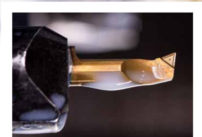
焼結チップブレイカーを採用した新世代のスーパーミニは、確実に切りくずを除去する。
