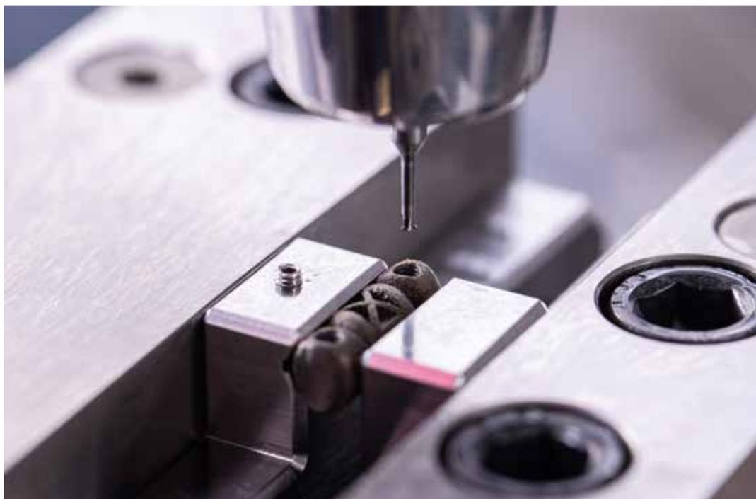
3Dプリントされたチタン部品にM3のめねじの加工をする
