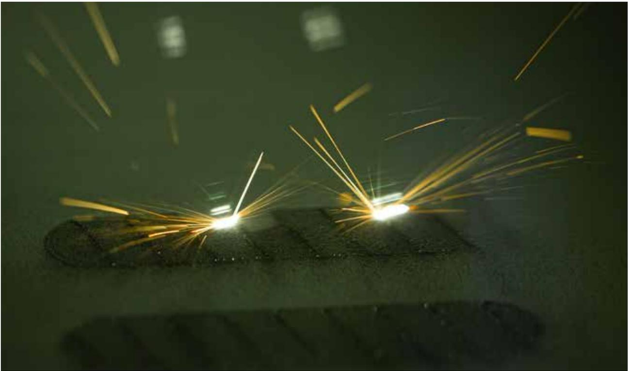
HORNは粉末床溶融結合法（パウダーベッド）として知られるレーザーによる溶融法を使っている
