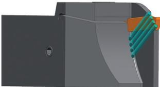
インサート側面のノズルから給油
