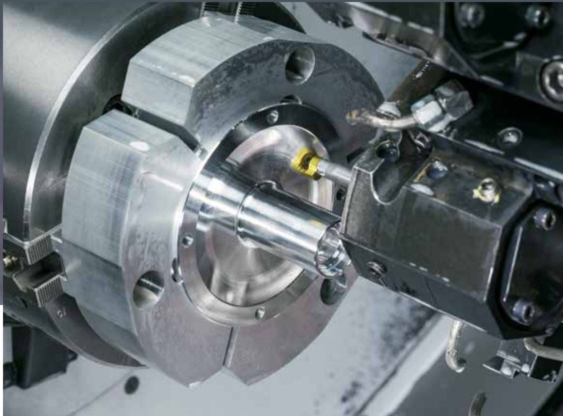
Mini R114軸の溝入れツールによる、小型の外径／凹面の仕上げ加工の様子。
