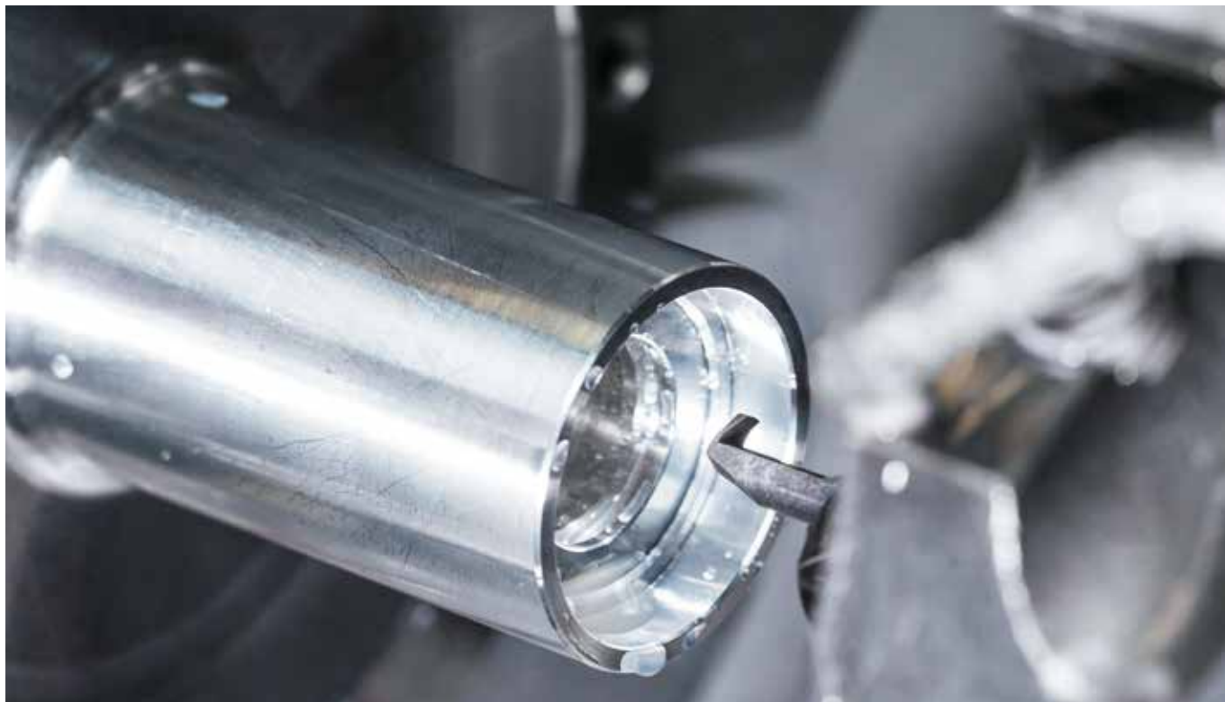
Superminiタイプ105を用いた、幅1mm の内径溝入れの様子。
