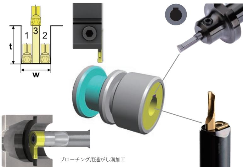
ブローチング用逃がし溝加工
