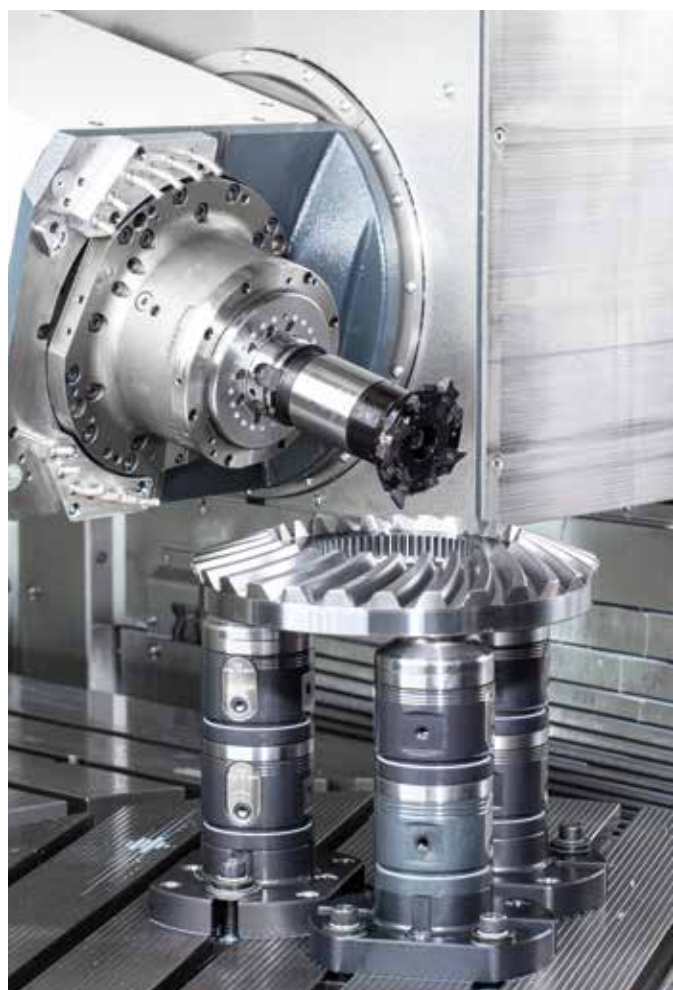
HORN製システムM279フライスカッター 曲がり傘歯歯車の粗加工工程
